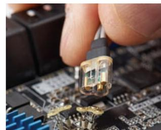
配有 N2849A QuickTip 探针的 N2848A QuickTip 探头
