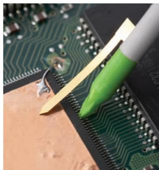
N287xA 探头的低电感接地连接保持探头低负载，以实现信号完整性测量。
