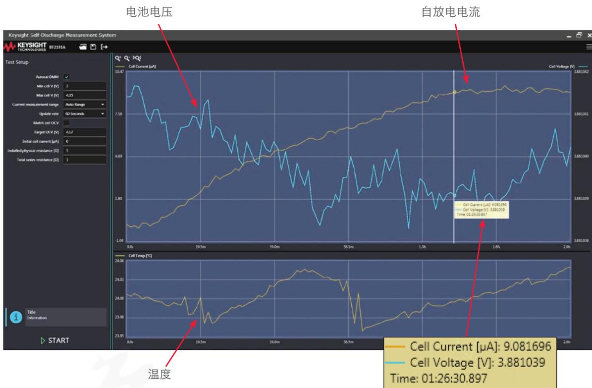
图 2. 良好 18650 电池的测试结果: 在约 1.5 小时测得 9.08 µA 的稳定自放电电流。
