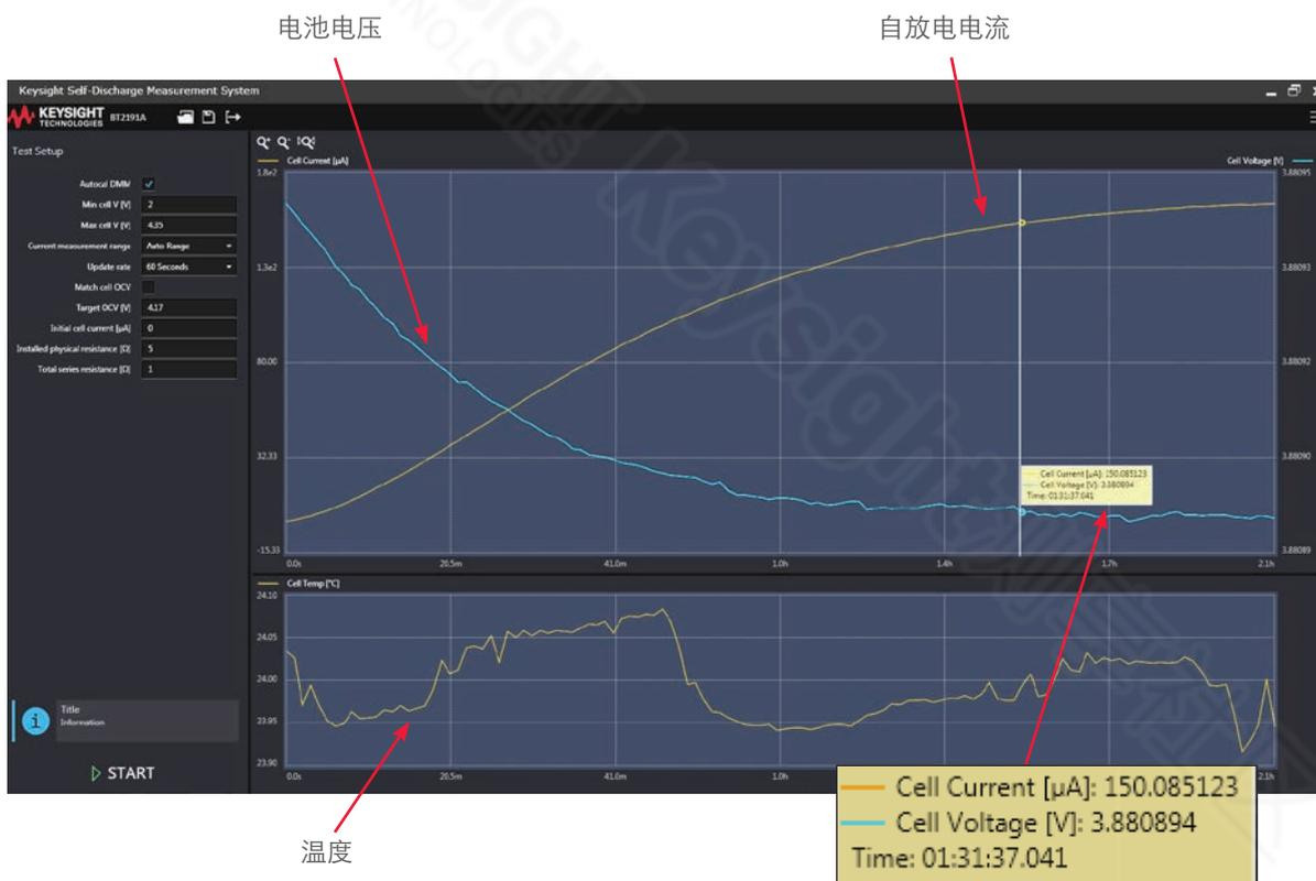
图 3. 高放电 18650 电池的测试结果: 在约 1.5 小时测得 150 µA 的稳定自放电电流。
