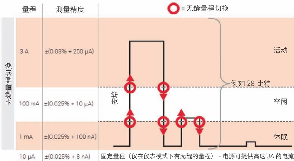
图 4. Keysight N6781A SMU 具有无缝量程功能，可以测量不同工作模式下亚  $\mu\text{A}$  至 3A 的电流。
