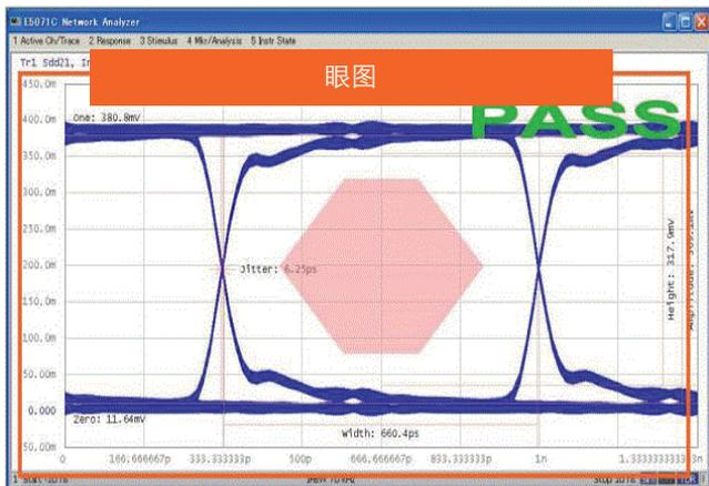
图 8. Keysight E5071C ENA 选件 TDR 为高速互连分析(包括阻抗、S 参数和眼图)提供了一款综合解决方案。
