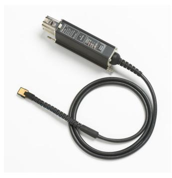
P7700 系列 TriMode 探头为实时示波器提供了最高的探头保 真度。此外, 凭借连接创新技术, 如焊接尖端中探头输入缓冲 器只安装在距尖端末端几毫米的地方, P7700 系列探头为连接 当今最具挑战性的电子设计提供了无可比拟的易用性。
